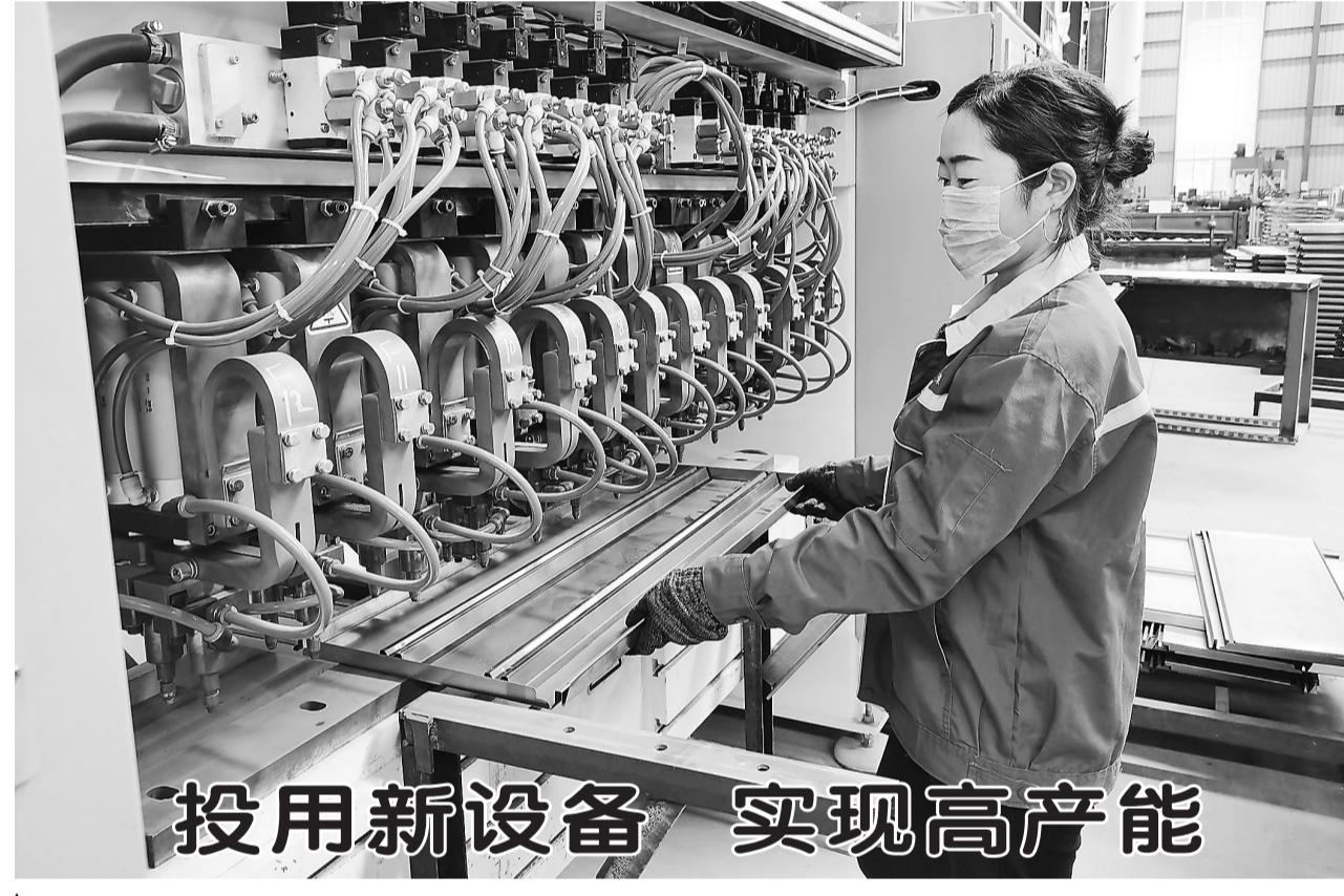
3月20日,在山东金贵货架有限公司生产车间内,技术员正在操作智能点焊机焊接层架。据了解,该公司位于菏泽高新区马岭岗镇安民返乡创业园内,主要生产超市货架、仓储货架、收银台等商场配套设备。因原有产能不能满足其发展需求,公司去年投资近300万元,购买了智能点焊机、数控折弯机、精密压力机等机器设备10余台。今年3月初公司复工复产以来,新设备的投入使用,降低了生产成本,提高了产品质量,生产效率提升50%,产能提升30%,使企业步入高质量发展快车道。记者 王燕 常鲁燕 摄
