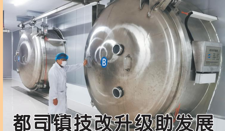
■日前,在牡丹区都司镇鲜康农业生产车间内,工作人员正在操作真空冷冻干燥机。都司镇鼓励企业实施技改转型升级,运用新技术赢得市场新发展。该公司进行了产品生产线升级改造,全部投产运营后,年生产冻干脱水蔬菜6000吨、储藏保鲜果蔬10000吨,助力当地脱贫攻坚。记者 李若生 通讯员 王引 摄
