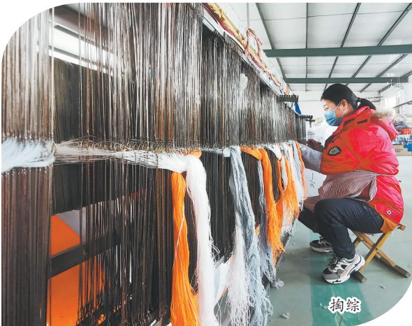
鲁锦织造工艺复杂,工人正在捻花,使每根线按照顺时针方向旋转,使线产生交叉
