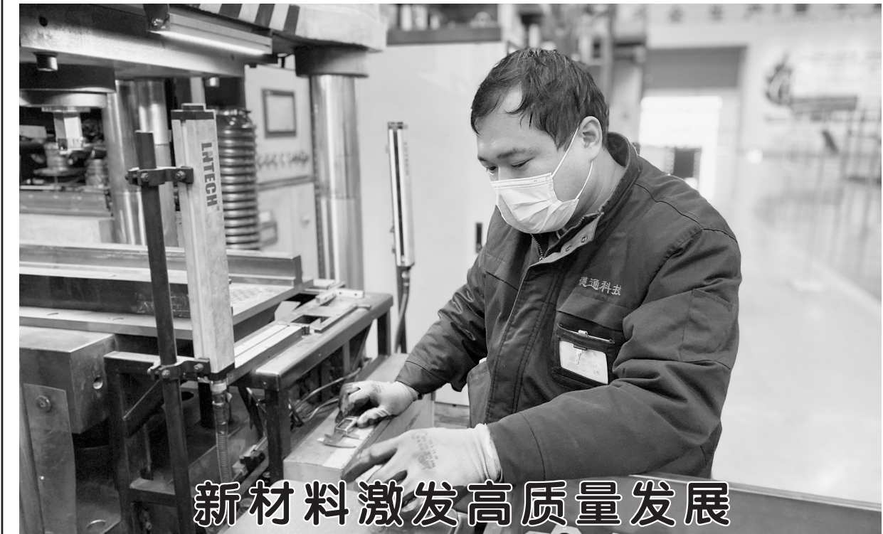
3月4日,在菏泽德通新材料科技有限公司生产车间内,生产动车刹车片的两条生产线正在有条不紊地运行。据了解,该公司是一家专业生产高铁及动车组用制动闸片的高新技术企业,产品分为粉末冶金材料产品和合成材料产品两大类,目前年产能达到40万件。
