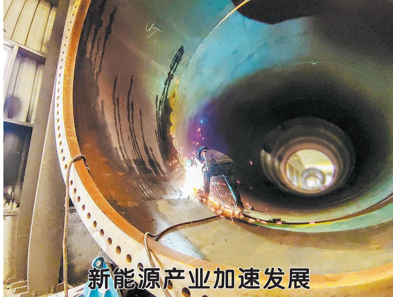
3月21日,在鄄城县天顺新能源年产500套风力发电塔架项目制造车间内,工人们正在进行风力发电塔筒修磨作业。据了解,该项目总投资5.21亿元,占地200亩,2020年5月建成投产,年产能达10万吨,拥有发明及实用新型专利近百项,其中,无碳刨焊接及防腐涂装等制造技术行业内领先,被VESTAS、GE、西门子等全球风电机组一致认可和青睐。
