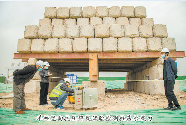
单桩竖向抗压静载试验检测桩基承载力
