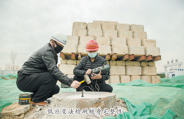
低应变法检测桩身完整性
