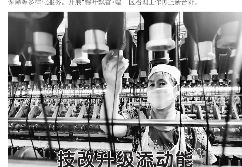
10月17日,牡丹区王浩屯镇乾鑫纱业有限公司生产车间内,纺织机械飞速运转,工人正在生产线上忙碌。近年来,王浩屯镇以新技术为抓手,加快企业技改升级步伐,支持企业加大技改投入,提升新工艺,研发新产品。目前,乾鑫纱业有限公司通过引进自动络筒机台、D81L并条机台等先进设备,可年产3000吨化纤涤纶纱线,产能提高30%,解决就业岗位200余个。记者 李若生 摄
