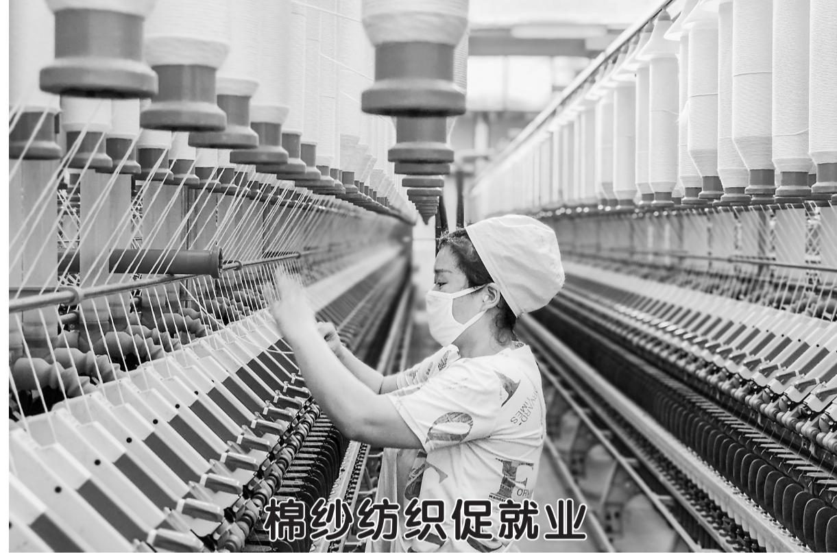
▲3月1日,在东明县武胜桥镇武胜桥村明胜纺织生产车间,工人正在纱机前巡回接头作业。据了解,该企业主要生产高、中、低支纯棉纱、混纺纱、化纤纱等产品,并引进了清梳联、瑞士立达并条机、德国来福自动络筒机等国内外先进生产设备。现有纺纱生产规模30万锭,年产棉纱2万余吨,年销售额5亿多元,带动2500余人就业增收。
