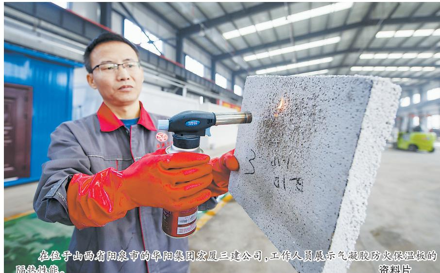
在位于山西省阳泉市的华阳集团宏厦三建公司,工作人员展示气凝胶防火保温板的隔热性能。
