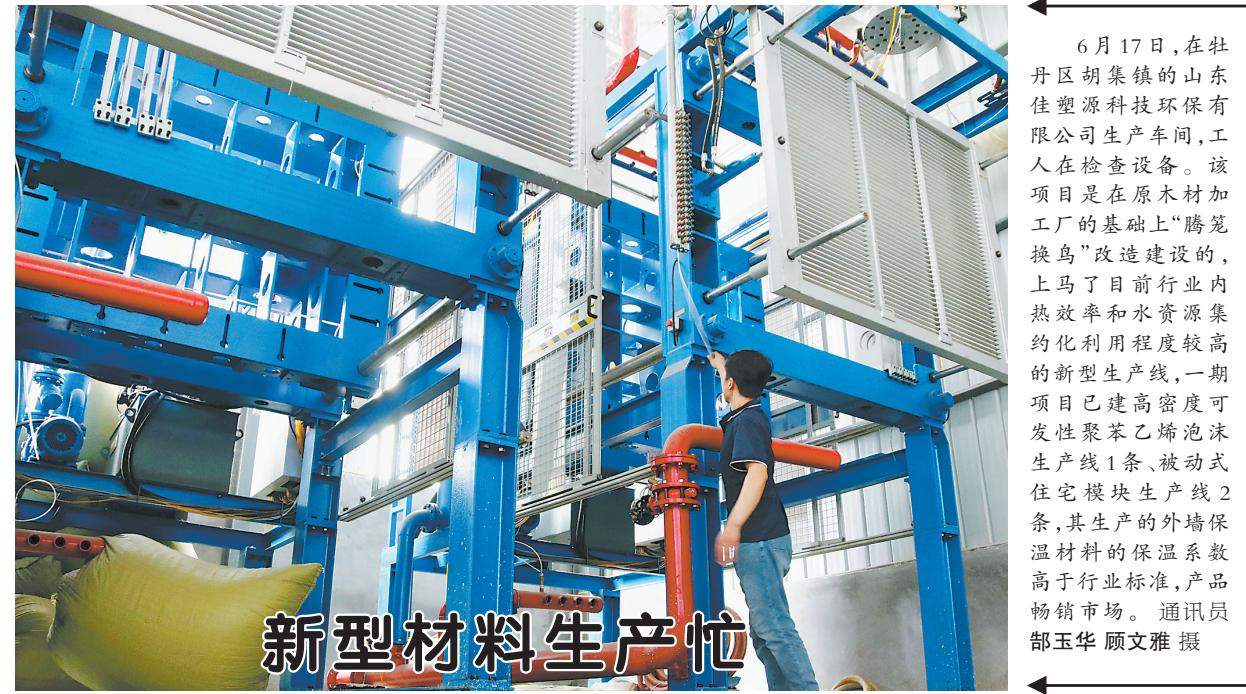
6月17日,在牡丹区胡集镇的山东佳塑源科技环保有限公司生产车间,工人在检查设备。该项目是在原木材加工厂的基础上“腾笼换鸟”改造建设的,上马了目前行业内热效率和水资源集约化利用程度较高的新型生产线,一期项目已建高密度可发性聚苯乙烯泡沫生产线1条、被动式住宅模块生产线2条,其生产的外墙保温材料的保温系数高于行业标准,产品畅销市场。通讯员 郭玉华 顾文雅 摄
