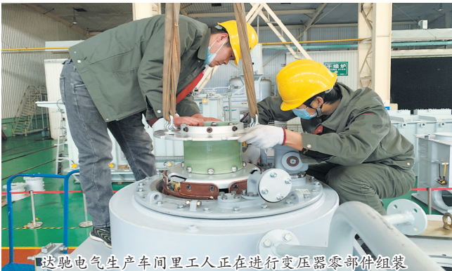
达驰电气生产车间里工人正在进行变压器零部件组装
