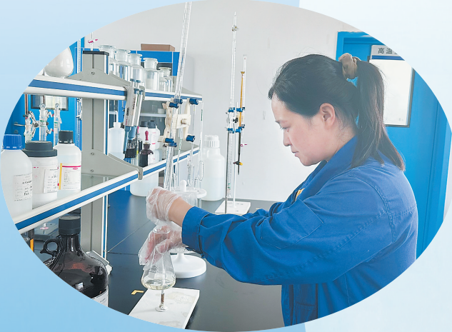
晨晖环保科技有限公司实验室里,技术人员正在做盐酸滴定实验
