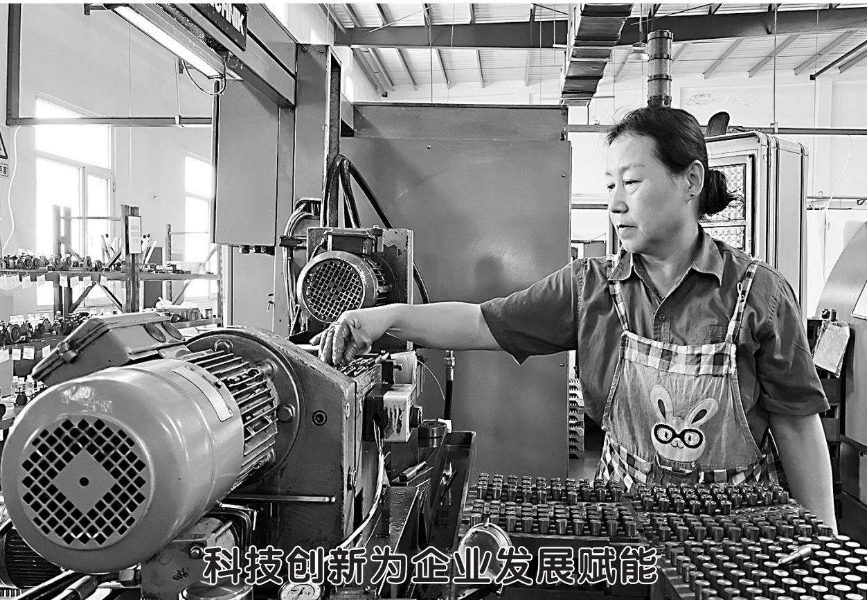
8月12日，鲁西新区菏泽华星油泵喷嘴有限公司生产车间，企业自主研发生产的电控高压共轨喷嘴偶件正在批量生产。据了解，多年来，该企业一直深耕柴油发动机配套产品喷嘴偶件，通过科技创新，打破技术壁垒，不仅让燃油雾化更加均匀，还实现了燃油系统从机械控制到电动控制的跨越，国内市场占有率超30%。
