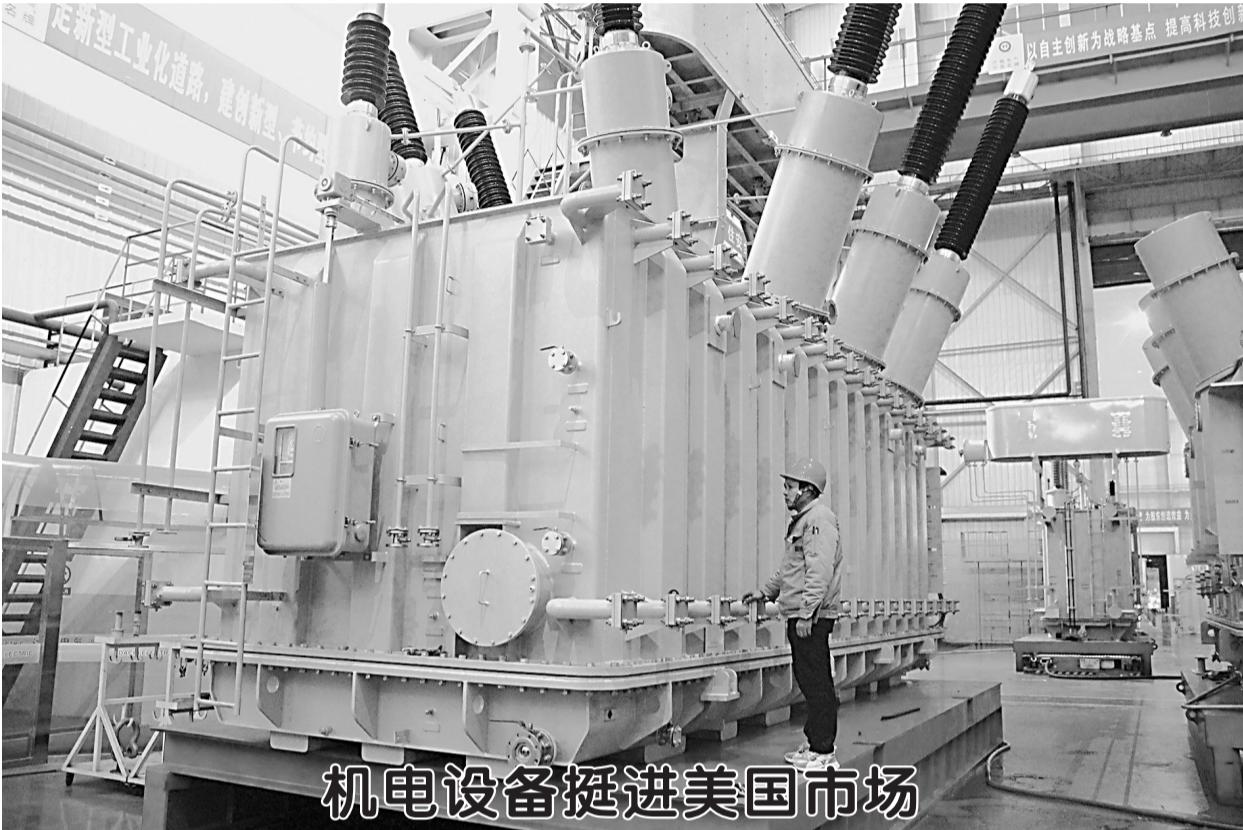
12月23日,在成武县山东达驰电气有限公司生产车间,技术人员正在检测220kV变压器。据了解,该公司是以生产输变电设备为主的高新技术企业,目前年产值10亿元左右。今年,该公司8项新产品(技术)顺利通过国家级鉴定,其中6项达到国际先进水平,2项达到国际领先水平。7月份,达驰电气成功中标美国德克萨斯州阿比林CE Longhorn数据中心发电项目,中标额3020万元,是其在美国市场的首笔订单。
