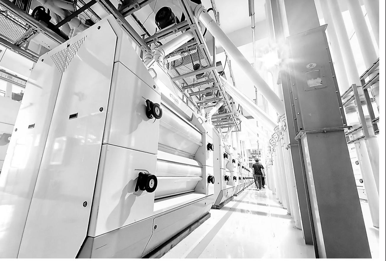
5月27日，在菏泽华瑞面业有限公司的智能化生产车间内，小麦经过反复研磨、筛选，最终形成不同品质的面粉。宽阔整洁的车间中几乎见不到人影。据悉，该公司通过数字化改造和设备更新换代，日加工小麦量达到1600吨，年产小麦粉24万吨，生产效率提升了35%。目前，华瑞面业已研发的产品涵盖六大系列、80多个品种。
