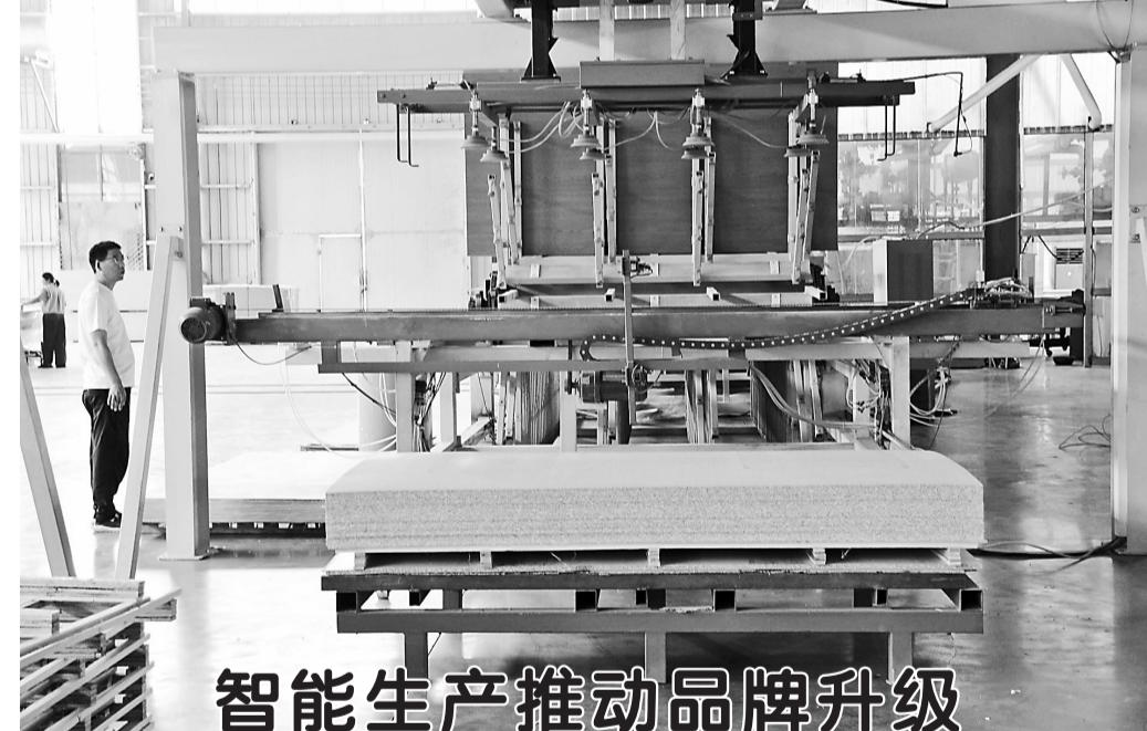
日前,在山东曹县上发新型材料有限公司生产车间内,工人正在操作国内领先的自动化贴面板生产线。该企业配备30余台多层次热压机及PUR贴面设备,形成年产能5万立方米生态板与3000套全屋定制家具。作为山东最大欧派代工厂,其在保障代工品质基础上持续研发投入,加速推进自有品牌建设,实现从代工生产向品牌化战略转型。
