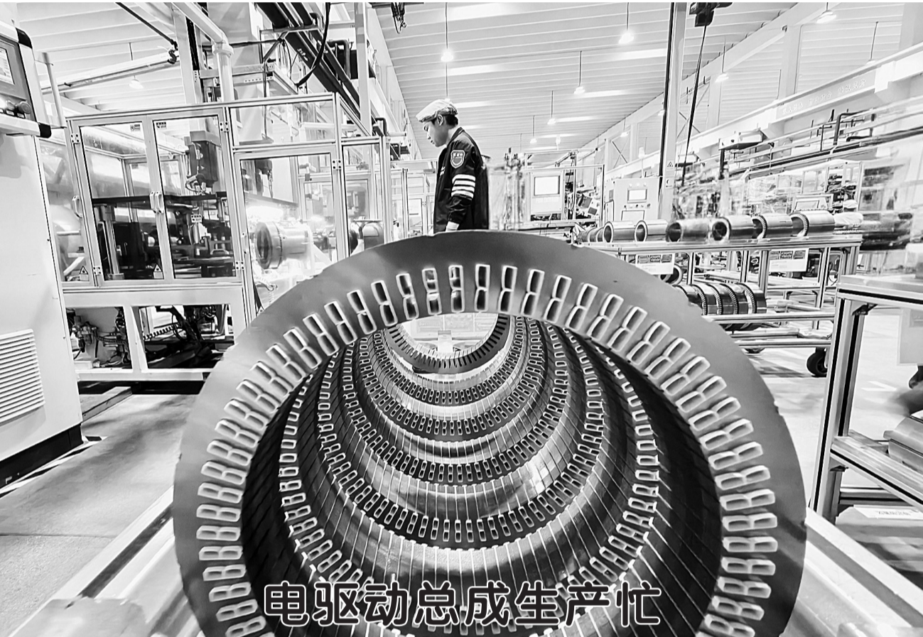
11月15日,精进电动科技(菏泽)有限公司车间内,工人正在加工电驱动总成相关配件。据悉,该公司自主研发的碳化硅大功率三合一电驱动系统,集成了扁线电机、SiC控制器、高效率减速器等先进子系统,性能卓越。其独创的油水复合冷却技术,有效解决了电控系统高速行驶时的散热瓶颈。该系统还可选配差速锁,提升了车辆在非铺装路面的通过能力。 记者 李若生 摄
