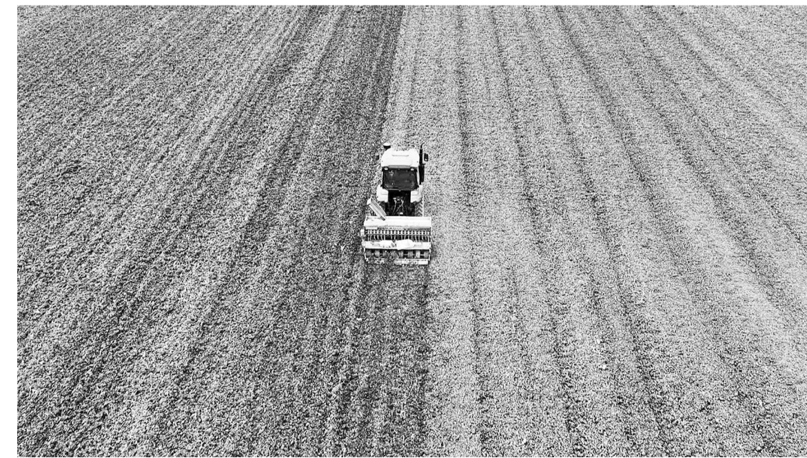
时下，东明县正值晚播小麦抢种关键期。受前期连续降雨影响，当地土壤湿黏，传统人工作业困难。田间地头，一台台自动化精量播种机开足马力，同步完成播种、施肥、覆土等多道工序。这种机械日均作业130亩，不仅效率远超人工，更能精准控制播深与间距，可有效保障出苗质量。 通讯员 薛博 单东法 摄
