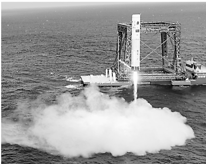
2月11日，长征十号运载火箭一级箭体按程序受控安全落落于预定海域。2月11日，我国在文昌航天发射场成功组织实施长征十号运载火箭系统低空演示验证与神舟载人飞船系统最大动压逃逸飞行试验。 新华社发
