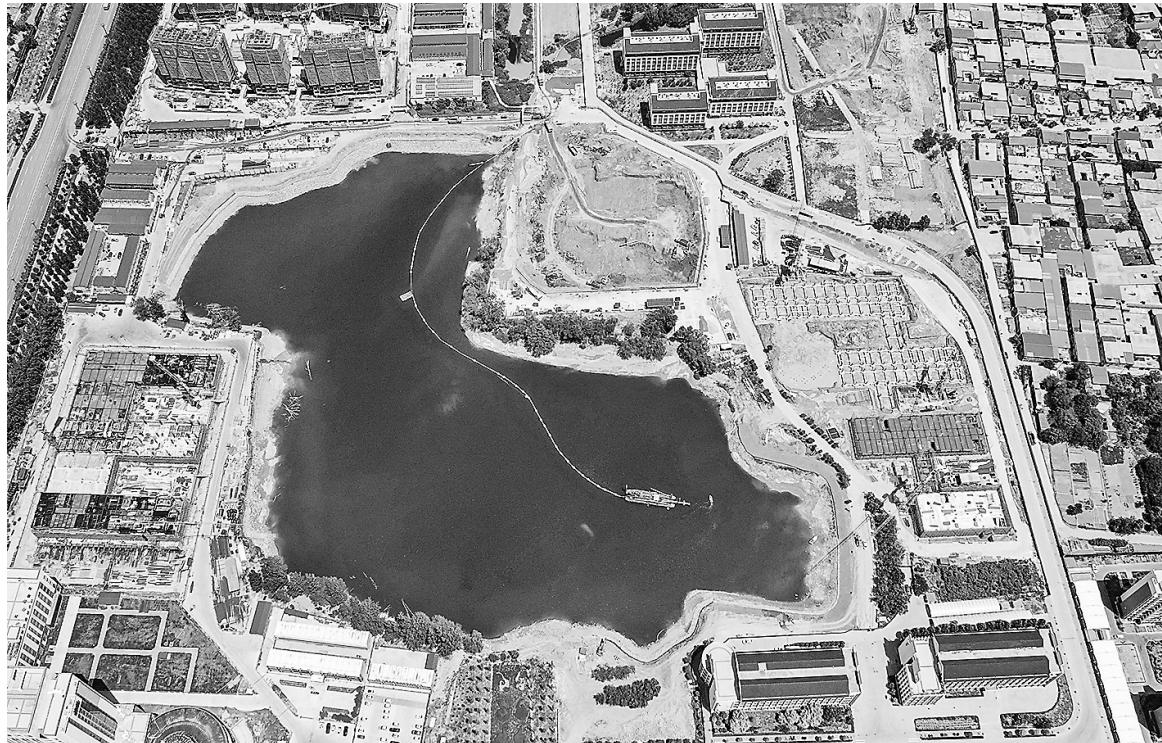
6月11日,环保绞吸船正在撤离万花湖。记者从市黑臭水体治理办公室获悉,作为菏泽首个黑臭水体治理项目——万花湖清淤工程完成验收。据了解,该工程水域面积约为6万平方米,采用环保绞吸船清淤,底泥密闭输送,土工管袋絮凝脱水的施工方法,建设脱水场地3.8万平方米,将万花湖黑臭底泥异地减容处置,累计清淤量6.81万立方米,历时3个月整治完毕,让万花湖实现了“水清岸绿、鱼翔浅底”的绿色生态空间。
