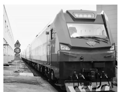
7月29日，单机功率28800千瓦、牵引力2280千牛的“神24”电力机车在中车株洲电力机车有限公司下线。这一超大功率电力机车的成功研制，标志着中国铁路重载技术创新取得重大突破。
