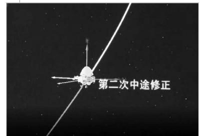
据中国探月工程官方微博消息，2020年9月20日23时，在我国首次火星探测任务飞行控制团队操作下，天问一号探测器4台120N发动机同时点火工作20秒，顺利完成第二次轨道中途修正，并在轨验证了120N发动机实际性能。
