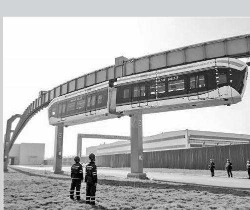
2020年11月9日,武汉市江夏区试验基地,中铁科工集团自主研发的悬挂式单轨列车在“空轨”试验线路实现了无人驾驶。中铁科工集团介绍,这条“空轨”试验线路全长800多米,是湖北省首条“空轨”试验线,在国内率先完成无人驾驶试验,无人驾驶系统具有全部商用功能。
