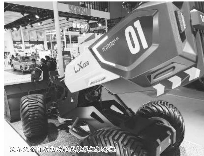
沃尔沃全自动电动轮式装载机概念机
