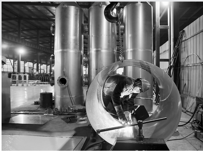
车间工人在焊接罐式发酵设备
