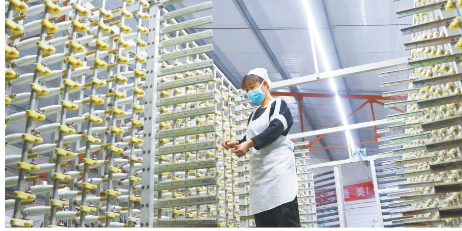
4月17日,在牡丹区高庄镇的牡丹区海盟绝缘材料有限公司,工人在加工玻璃纤维。据公司经理万宏斌介绍,该公司今年实施了技改升级,将原来的老织布机升级为喷气织机,全部自动化生产,效率提高了6倍,质量进一步提高。近年来,该镇持续加大招商引资力度,通过腾笼换鸟、技改升级等方式加速了项目建设和企业发展。 通讯员 郭玉华 宋杰 高志房 摄
