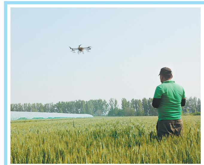
5月8日,在牡丹区吴店镇后葛庄,植保无人机帮助农民对小麦进行大规模喷药作业,为小麦丰收打下基础。据了解,植保无人机一天可喷洒农药面积300至500亩,不仅提高了作业效率,消除了人工打药中毒隐患,还减少了对环境的污染,深受种植户的欢迎。
