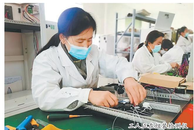
工人正在组装检测仪
